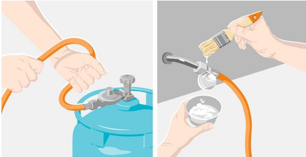
Abbildung 2: Verificare che il tubo flessibile non presenti segni di usura e che sia ancora sufficientemente elastico. Anche se gli attacchi sono stretti bene, si formano delle bolle facendo il test con l'acqua saponata! Il rischio di esplosione è elevato: il tubo flessibile deve essere immediatamente sostituito!
